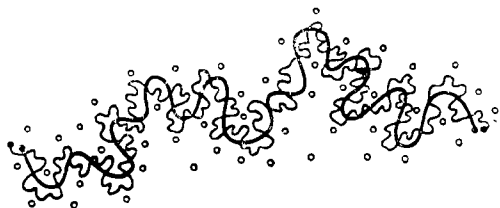
图 4.1 缠结的模糊约束模型 细线代表实际分子链段, 作步长为 l 的无规行走; 粗线代表其瞬态平衡位置轨迹, 作步长为 a 的无规行走 ( a 比 l 大得多)。空心圆圈代表周围分子链段, 实心圆圈代表结点
