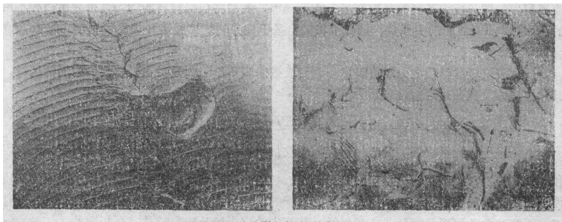
图 1 条纹状裂纹表面和脆断粒子表面 (a) \Delta K \approx 8 \text{MPa}\sqrt{\text{m}} ; (b) \Delta K \approx 10.3 \text{MPa}\sqrt{\text{m}}
