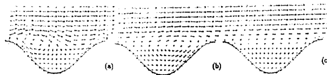
图10 动波浪壁流的相对速度场。 a = 0.2 ； c/U = 0.414 ；时间 t 为：(a) 2.1 (b) 6.01 (c) 19.01
