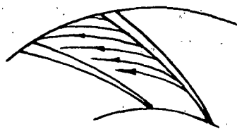
图7(b) 试验后扩压器前后侧壁的油烟痕迹
