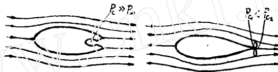
图 5 通常用推进发动机来产生补偿阻力的推力，推进发动机向物体后部提供推进压力
