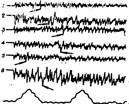
图5 圆柱壳几个不同位置的典型应变 [20] . 编号 1—5 代表测量点, 箭头对应应变跳变发生
