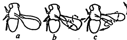
图 2 在“拍击-挥摆”过程中,翅膀的运动产生非定常力。各翅拍在一起 (a), 然后前缘先旋转 (b), 空气冲进空隙 (虚线箭头), 并且绕翅形成环流以开始下次拍击 (c)
